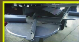
دو عدد دیسک پاشنده جهت پاشش یکنواخت
