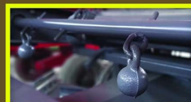
خردکن با گوی فولادی قابل تعویض
